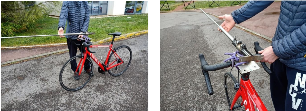
Figure 19 - Photos de l'expérience consistant à mesurer l'allongement des ressorts lors des phases d'accélération et de décélération du vélo
