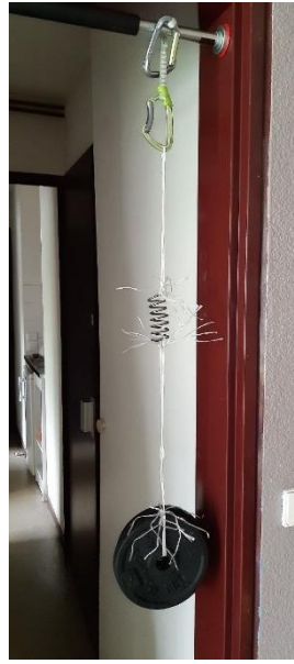
Figure 18 - Schéma de la mesure de la raideur d'un ressort et photo de l'expérience
